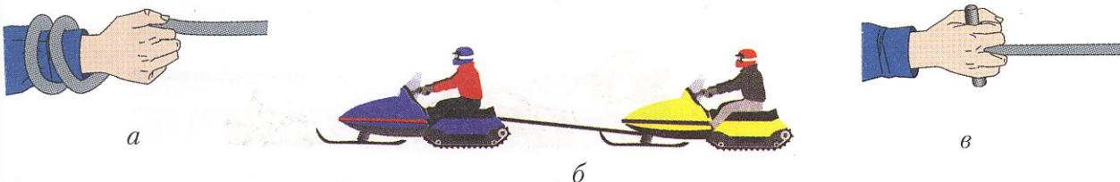
1. Запускать двигатель с помощью аварийного шнура, обмотав его вокруг руки (а).
